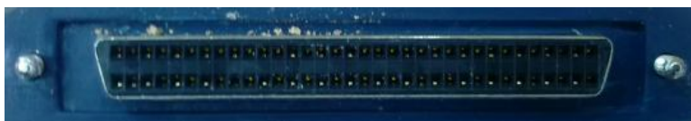
Рис. 3.43. 68-контактный разъем кабеля типа SH68-68 для подключения платы CB-68LPR к другим устройствам
